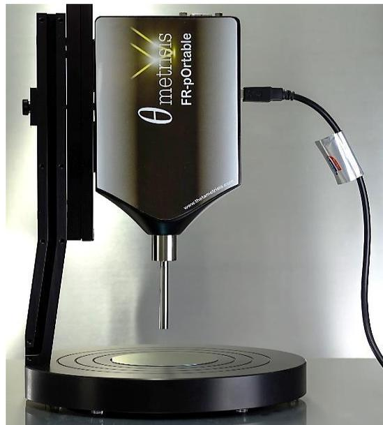
Благодаря компактным размерам, специально разработанному отражательному зонду и широкополосному источнику света с длительным сроком службы FR-pOrtable позволяет проводить высокоточные и воспроизводимые измерения.
